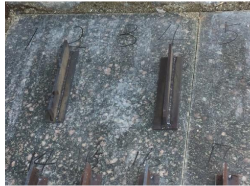
訓練生によりすみ肉溶接された試験体
