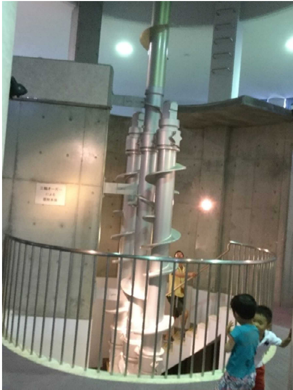
地下連続壁を施工するドリル
