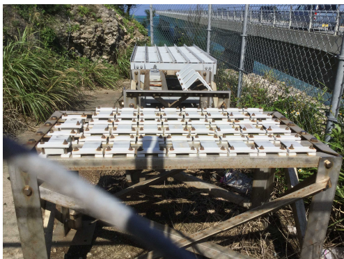
鋼材の腐食を調べる暴露試験
