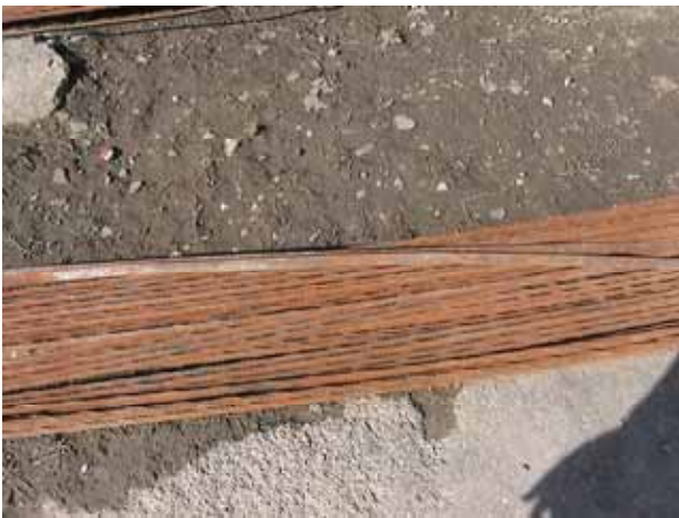
変わった種類の異形鉄筋
